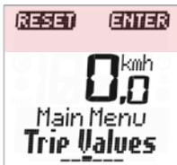
Если функция активирована, меню навигации появляется при каждом следующем нажатии одной из двух функциональных кнопок. Нажмите одну из верхних функциональных кнопок. На дисплее покажутся многочисленные функции. После того, как Вы ознакомитесь со всеми функциями меню, нажатием кнопки (см. распределение кнопок) Вы сможете установить выбранные Вами функции.
