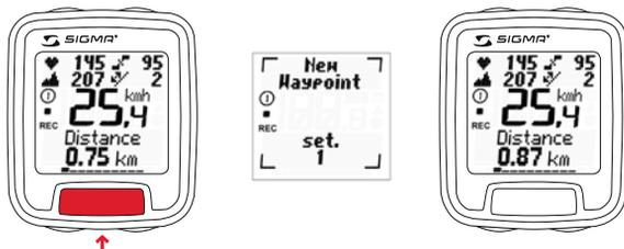
**Opmerking:** U kunt alleen een routepunt in de voorinstelde opslaginterval (opslaan elke 5, 10, 20 of 30 seconden) vastleggen. Als u probeert een tweede routepunt binnen de tijdsinterval vast te leggen, verschijnt de melding:
