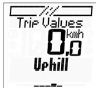
Alle bergopfuncties zijn onder: „ritgegevens/bergop“ te vinden. De volgende functies zijn onderdeel van de submenu's: hoogtemeter/max. hoogte/afstand/rijtijd/Ø-snelheid/stijgingssnelheid/max. stijgingssnelheid/Ø-stijging/max. stijging.
