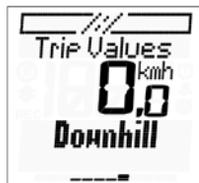
Alle bergaffuncties zijn onder: „ritgegevens/bergaf“ te vinden. De volgende functies zijn onderdeel van de submenu's: hoogtemeter/afstand/rijtijd/Ø-snelheid/stijgingssnelheid/max. stijgingssnelheid/Ø-stijging/max. stijging.
