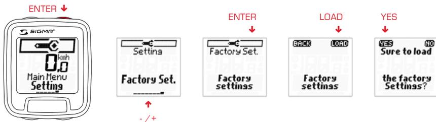
Po przywróceniu ustawień fabrycznych urządzenia SIGMA ROX 9.0 komputer rowerowy wraca do trybu głębokiego uśpienia.
