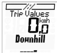
Все функции спуска находятся под указателем „Downhill“. Следующие функции являются частью дополнительного меню: Измерение высоты/Дистанция/Время поездки/Средняя скорость/Скорость подъема/Макс. скорость подъема/Средний подъем/Макс. подъем.
