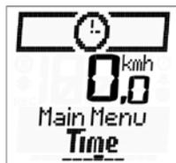
Все функции времени находятся под указателем „Time“. Следующие функции являются частью дополнительного меню: Время/Дата/Секундомер/Таймер/Будильник.
